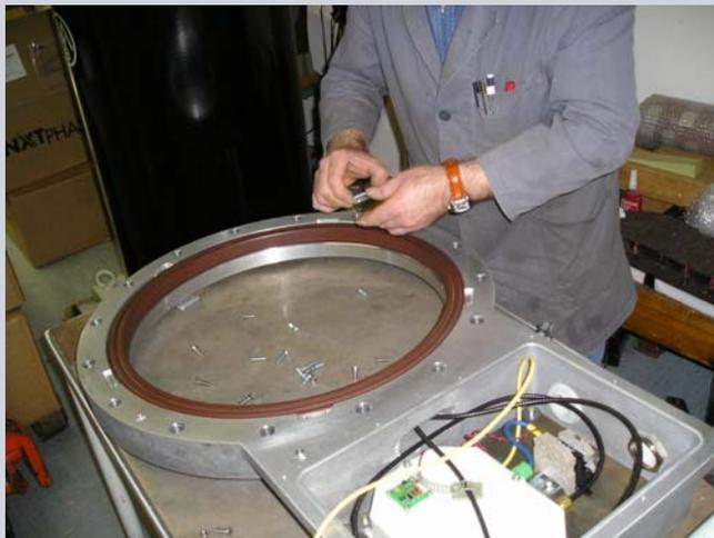
Montaje de un Trafo óptico de NXTPHASE en Trench para la 8DQ1- Singer USA
